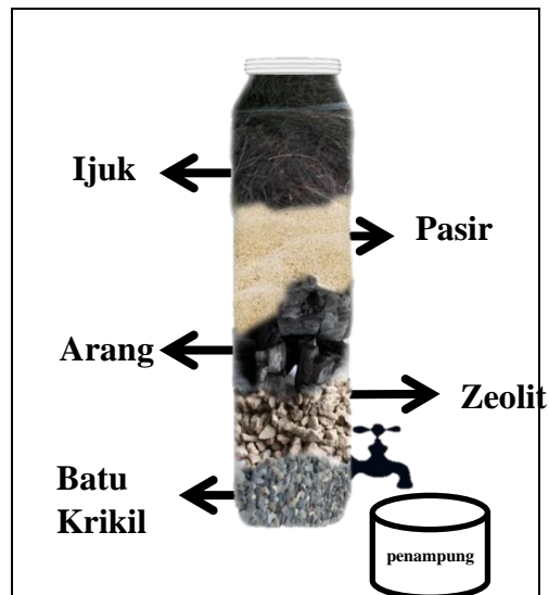
Gambar 1. Struktur bahan dalam alat
